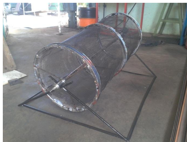
Fig 2: Earthworm trommel separator
